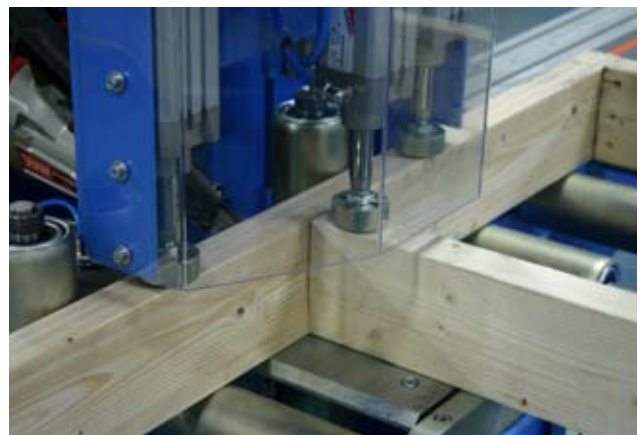
Widok z bliska systemu mocującego zainstalowanego na stacji FM1000 – wysoką jakość i wydajność produkcji drewnianych szkieletów.
