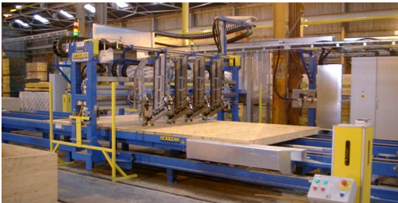
Możliwość stosowania mostu zbijającego ze sterowaniem CAD/CAM lub sterowaniem manualny NB1000F
