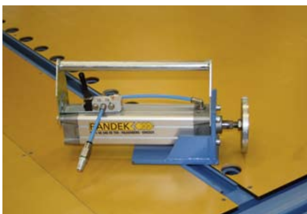
Belki otworowe zapewniające uniwersalne mocowanie pod każdym kątem
