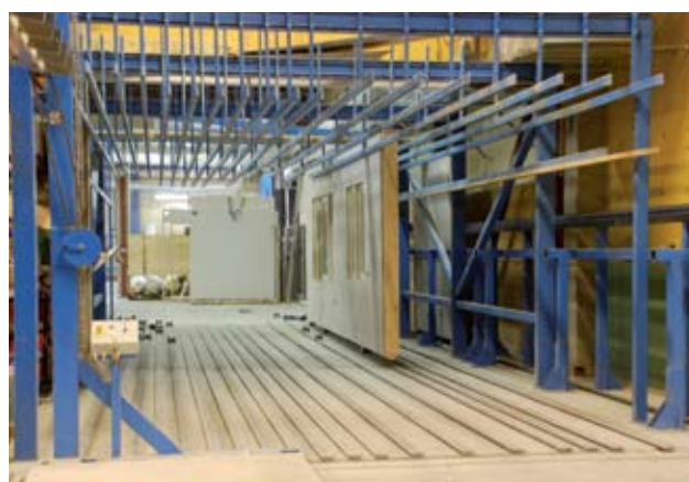
Składane bolce umożliwiają wyprowadzenie ściany ustawionej w pozycji pionowej bezpośrednio do magazynu.
